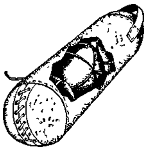
Рис. 10. Катки и кранцы из футбольных камер
