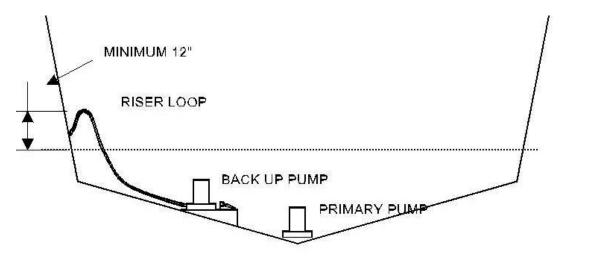
RECOMMENDED INSTALLATION ARRANGEMENT FOR BACK UP BILGE PUMP
