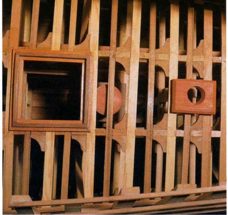
▲ Escotillas, cabilleros y fogonaduras. Cualquier detalle mejora sensiblemente la construcción.
