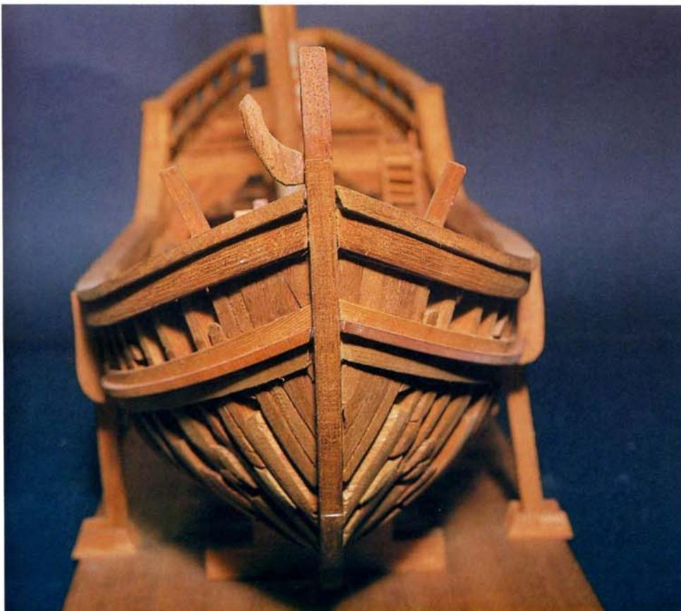
te todo aquello que tengamos programado: bitas para las anclas, cabrestantes, tabiques, cámaras, fognaduras en los mástiles, así como el forro interno entre cubiertas. Este forro deja cada cierto número de tracas un espacio abierto de ventilación, por el que se pueden ver las cuadernas.
