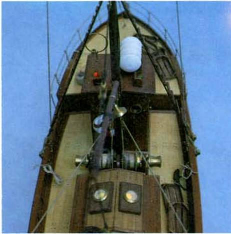
En algunos casos el modelista puede añadir a sus modelos, detalles de gran vistosidad que realcen la belleza del conjunto como es el caso de este modelo, al que su autor ha dotado de luces de posición y dentro del barco que se encienden mediante un mecanismo a pilas.
