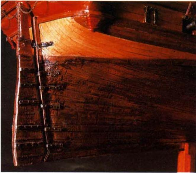
Este impresionante aspecto de forro de cobre se obtuvo mediante el tratamiento del metal con pátinas.
