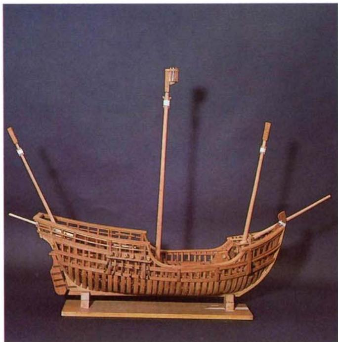
Fogonaduras de mástiles. Entre éstos y la abertura se colocaban unas cuñas introducidas a presión para corregir la inclinación de los palos y fijarlos.
