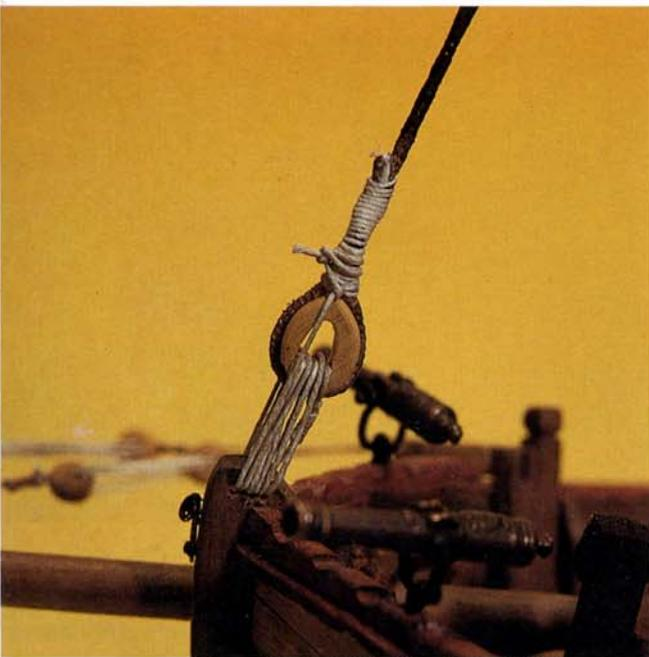
▲ El extremo del estay del mástil termina en una vigota simple de gran tamaño unida a la cabeza de la roda. Observar el forro del estay.
