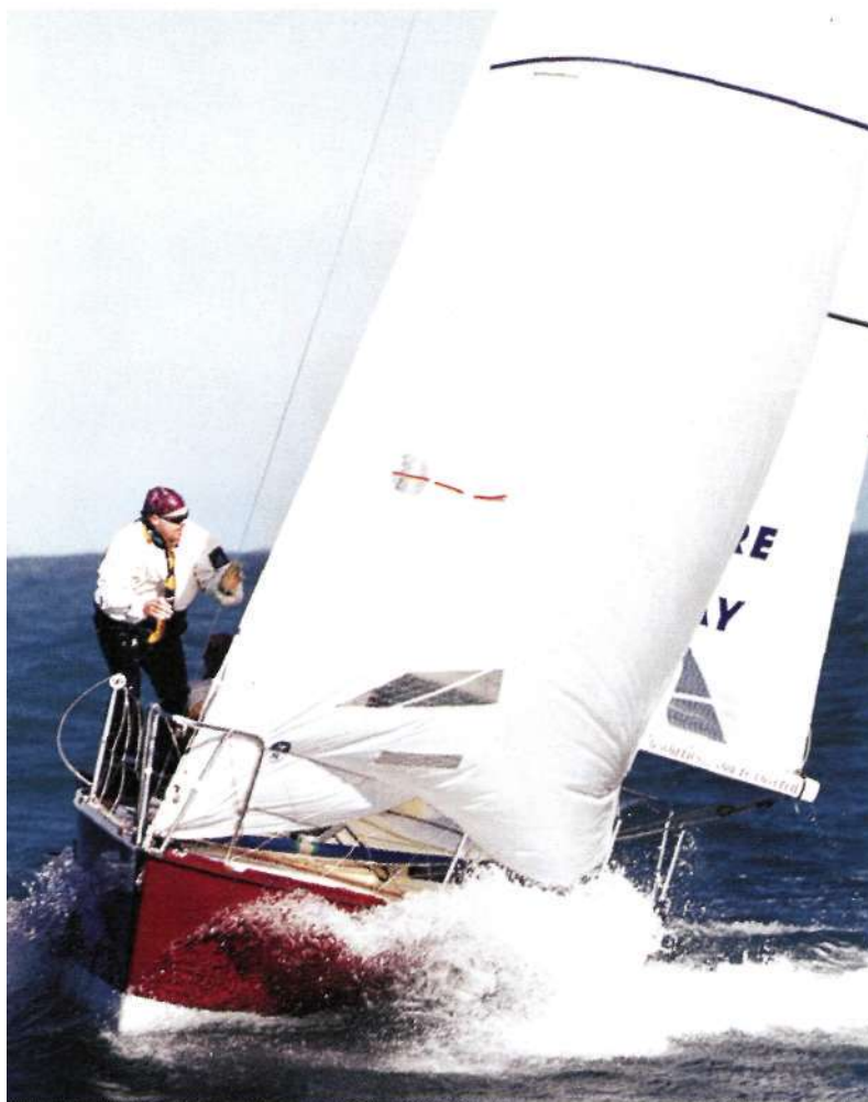
Когда выпелы, или «колдунчики», находятся в горизонтальном положении, яхта идет под оптимальным углом к ветру. «Колдунчики» обычно помещают за передней шкаториной паруса
