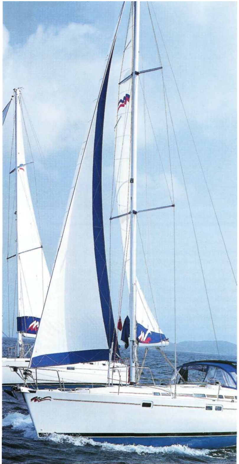
Мачта, рангоут и такелаж померзживают паруса и позволяют установить их соответственно ветру
